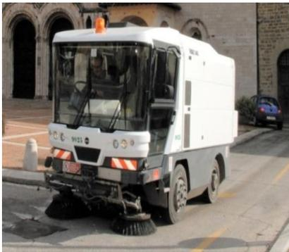
Lo **spazzamento meccanico** viene eseguito mediante macchine spazzatrici di tipo aspirante di medie dimensioni per il centro urbano e di grandi dimensioni per le frazioni e per le strade di scorrimento. Le macchine operano secondo un programma di interventi e itinerari determinati e rintracciabili in cartografia numerica. Le frequenze di spazzamento sono definite a seconda delle esigenze ed in ordine alle caratteristiche urbanistiche del territorio e dei flussi pedonali.
